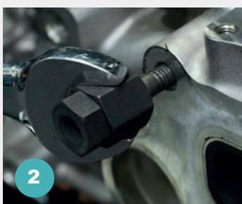
Демонтировать резьбовую шпильку, используя гаечный ключ 22 мм. Приспособление вместе с резьбовой шпилькой необходимо вращать против часовой стрелки (для правой резьбы), используя шестигранный рабочий профиль большей части приспособления.
