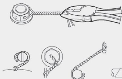
Примеры фиксации резьбовых соединений при помощи плоскогубцев для скручивания проволоки (твистеров).
