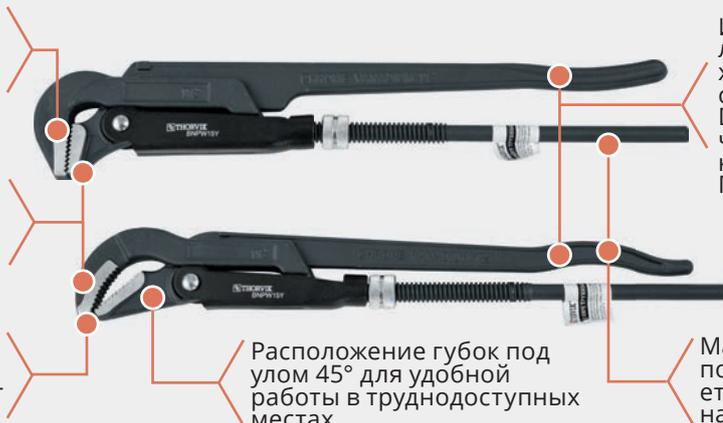
Инструменты изготовлены из легированной хромованадиевой стали, по стандарту DIN 5234 (Form A,C), что соответствует техническим условиям ГОСТ 18981-73
