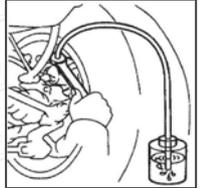
5.2 Закрыть крышку рабочей емкости и соединить шланг для слива отработанной жидкости и штуцер прокачки, который расположен на тормозном суппорте. В случае, если тормозной суппорт имеет два штуцера, то необходимо использовать тройник и трубки, входящие в комплект поставки.
