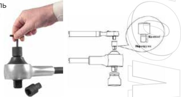
3. Установить мультипликатор вместе с торцевой головкой на гайку или головку болта. В зависимости от необходимой технологической операции, использовать вороток или динамометрический ключ, предварительно установив в гнездо адаптера-предохранителя. Ручка мультипликатора используется в качестве упора. Устанавливается против предполагаемого направления вращения.
