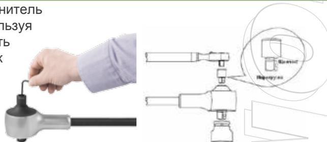
3. Установить мультипликатор вместе с торцевой головкой на гайку или головку болта. В зависимости от необходимой технологической операции, использовать вороток или динамометрический ключ, предварительно установив в гнездо адаптера-предохранителя. Ручка мультипликатора используется в качестве упора. Устанавливается против предполагаемого направления вращения.
